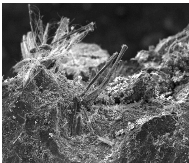
Fot. 9. Odlamane narożniki płyty eternitowej – zdjęcie mikro i makroskopowe.
